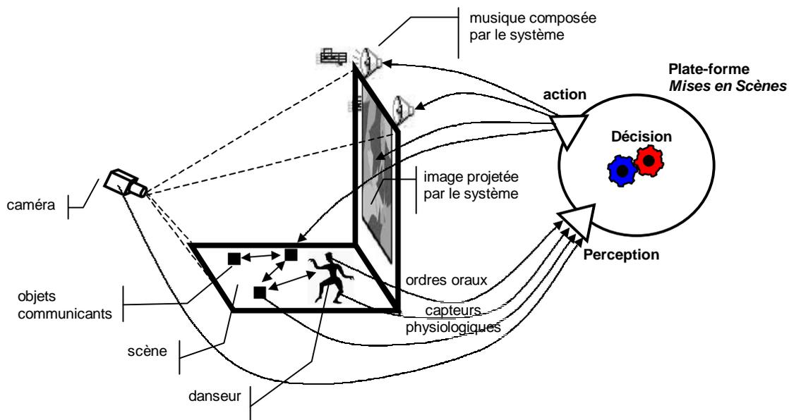
*Figure 1. Le système informatique autonome perçoit les évolutions du danseur par l'intermédiaire de capteurs appropriés, décide d'une réponse adaptée et la réalise.*
